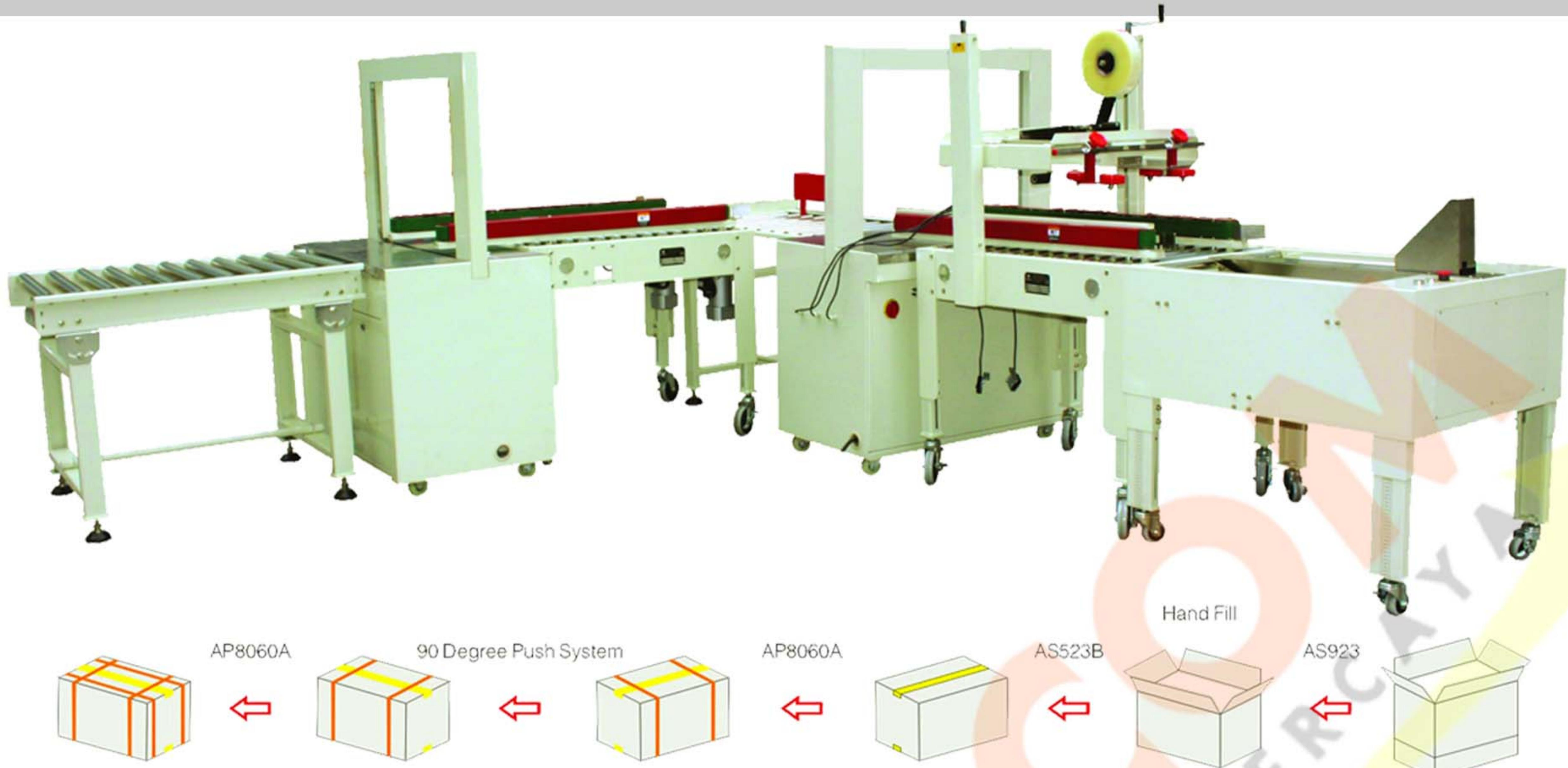
Mesin ini merupakan kombinasi mesin pengepakan kardus. Mulai dari pembentukan kardus, menutup segel bagian bawah & atas kardus serta mengikat kardus dengan erat. Semua proses tersebut berjalan otomatis. prinsip mesin ini sangat menghemat waktu/ruangan dan biaya produksi
