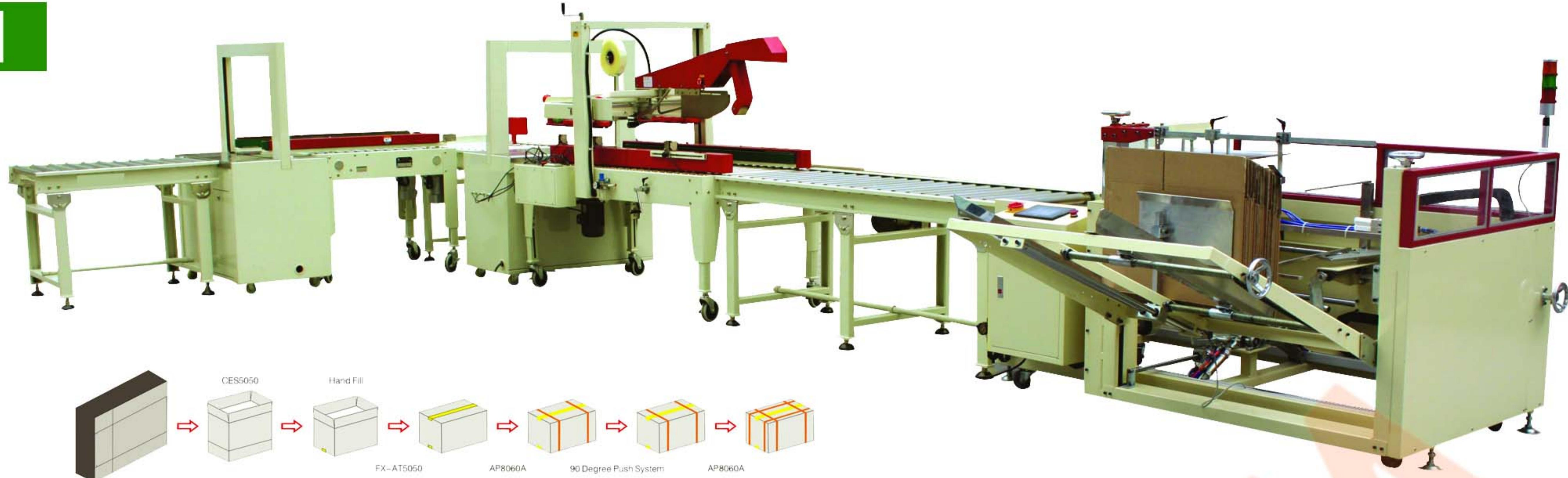
Mesin ini merupakan kombinasi mesin pengepakan kardus. Mulai dari pembentukan kardus, menutup segel bagian bawah & atas kardus serta mengikat kardus dengan erat. Semua proses tersebut berjalan otomatis. prinsip mesin ini sangat menghemat waktu/ruangan dan biaya produksi
